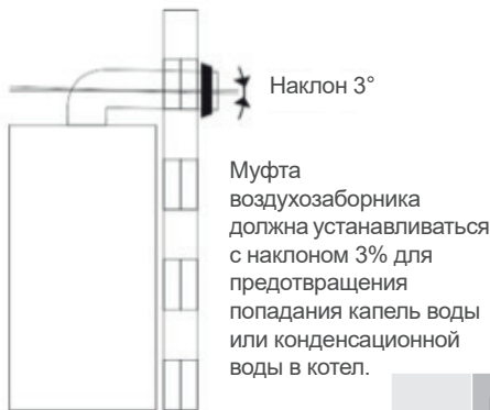
Рисунок 9. Наклон конденсора
